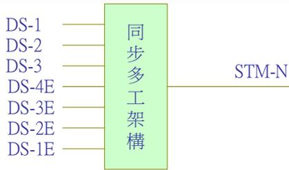
圖 14-12 SDH 的多工方式
