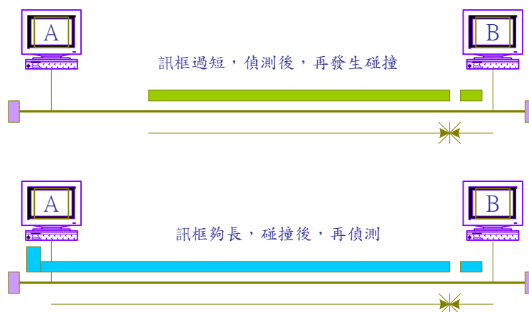
圖 2-11 訊框長度與碰撞偵測
